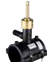
EF VALVE TAPPING TEE (VA TYPE) EF VANALI SERVİS TE (VA TİPİ) SDR 11 PE100 GAS / GAZ : 10 BAR WATER / SU : 16 BAR
