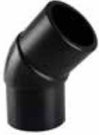
ELBOW (45°) / DİRSEK (45°) SDR17 PE100 GAS/GAZ : 6 BAR WATER/SU : 10 BAR TYPE/TİP : SPIGOT
